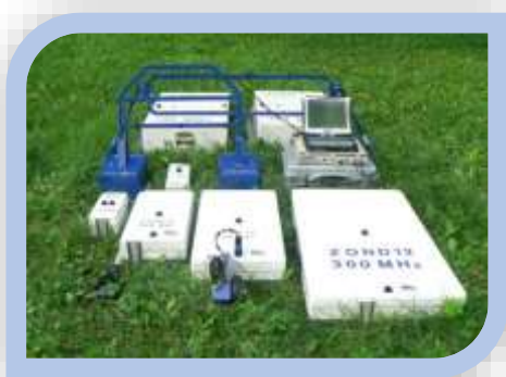
Ilustrācija 5. Radiolokācijas pētījumu iekārta, jeb ģeoradars Zond 12. http://www.radsys.lv/en/products-soft/products/prod/4
