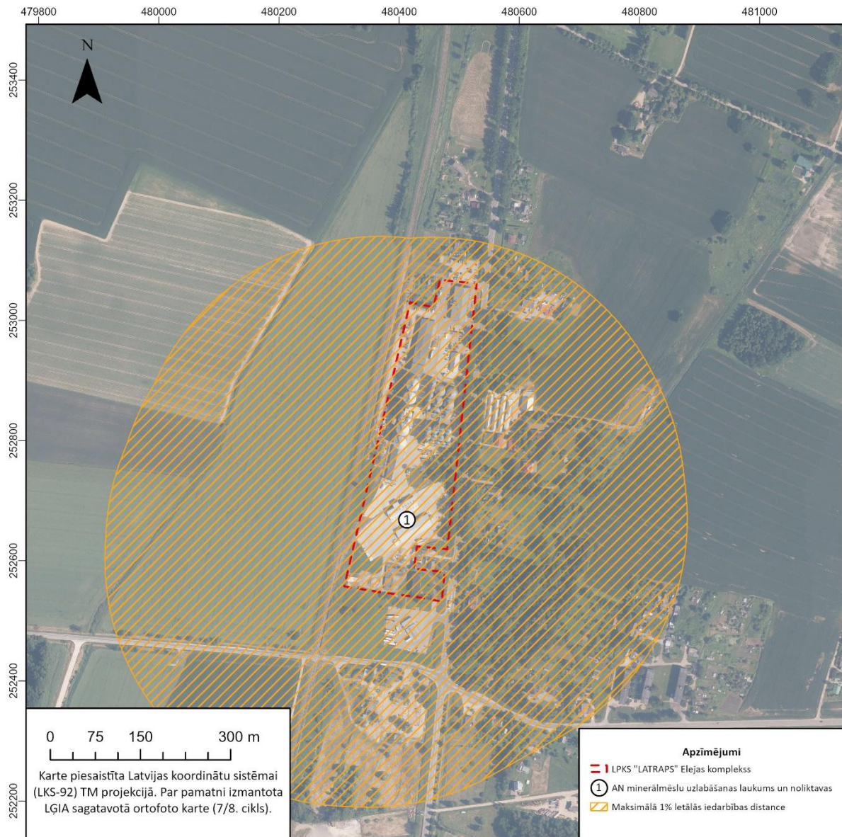
6.1. attēls. Maksimālās 1% letālās iedarbības distance ugunsgrēka gadījumā, kā rezultātā notiek AN minerālmēslu termiska sadalīšanās minerālmēslu noliktavā
